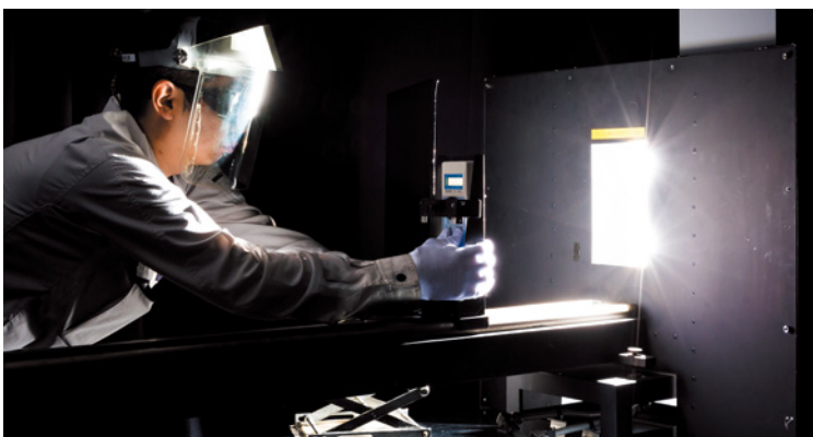
放射照度計の校正作業
