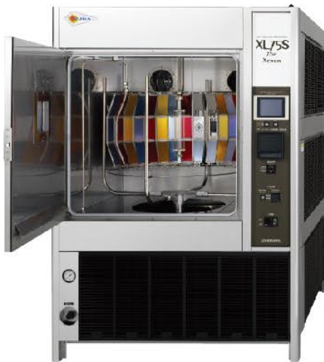
写真1. -40℃まで制御できる 低温サイクルキセノンウェザーメーター XL75S型
