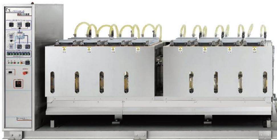
バラスタタンク 腐食試験装置
