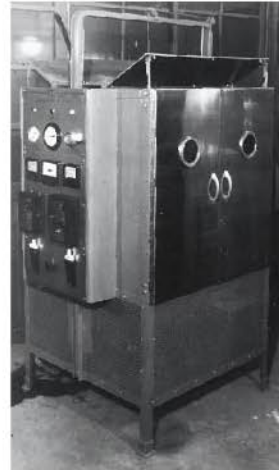
国産第1号 紫外線カーボンアーク灯式 ウェザーメーター
