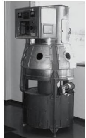
国産第1号 紫外線カーボンアーク灯式 フェードメーター
