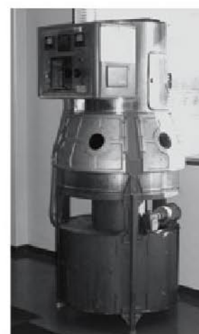
国産第1号 紫外線カーボンアーク灯式 フェードメーター
