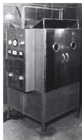
国産第1号 紫外線カーボンアーク灯式 ウェザーメーター
