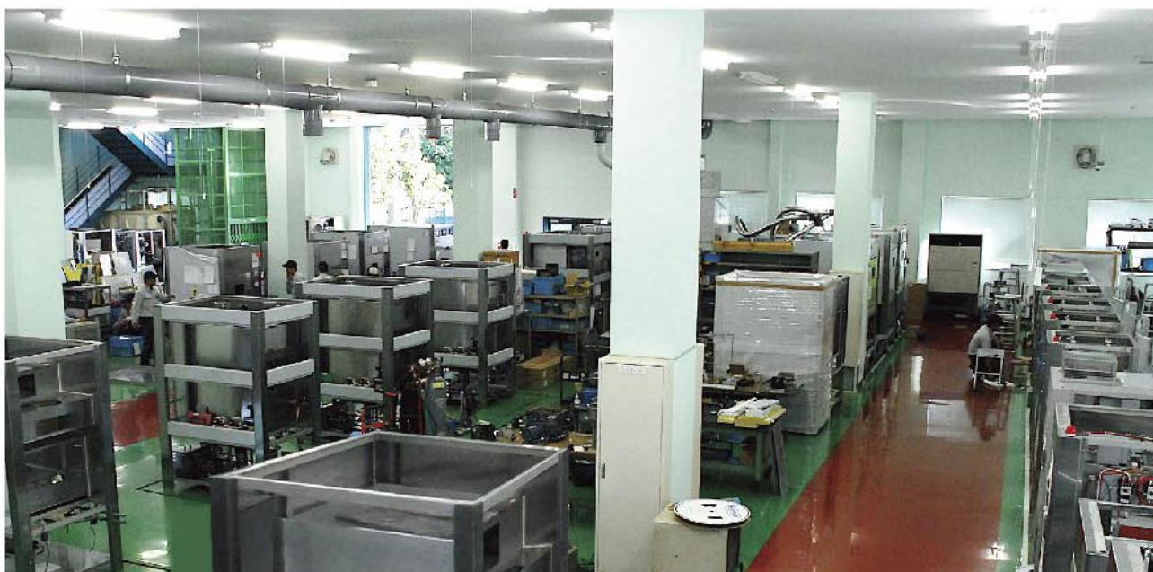
キセノン、サンシャインなど促進耐候性試験機の生産ライン (5号館2009年10月撮影)
