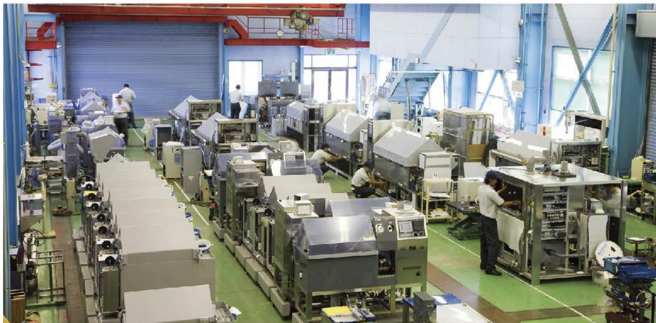
塩水噴霧、複合サイクル試験機など腐食促進試験機の生産ライン (3号館2009年10月撮影)
