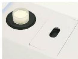
反射測定は、試料台に試料をのせて。
