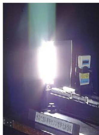
7.5kWキセノンアークランプによる放射照度計の校正
