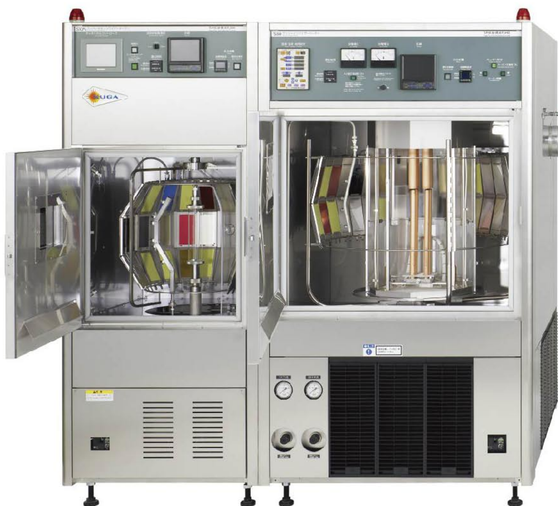
左槽 7.5kWキセノンランプ
