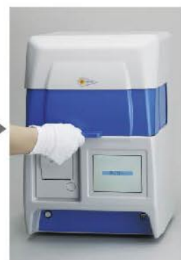
試料扉を閉めて 自動測定開始 （測定時間最大2.5秒）
