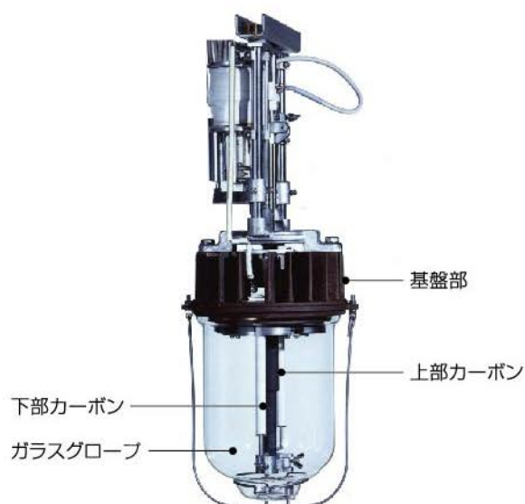
写真1. 紫外線カーボンアークランプ
