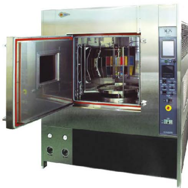
写真1. 温度サイクル型キセノンウェザーメーター（XL75S型） -40^{\circ}\text{C} ～ +150^{\circ}\text{C} の広い温度範囲の試験ができます。
