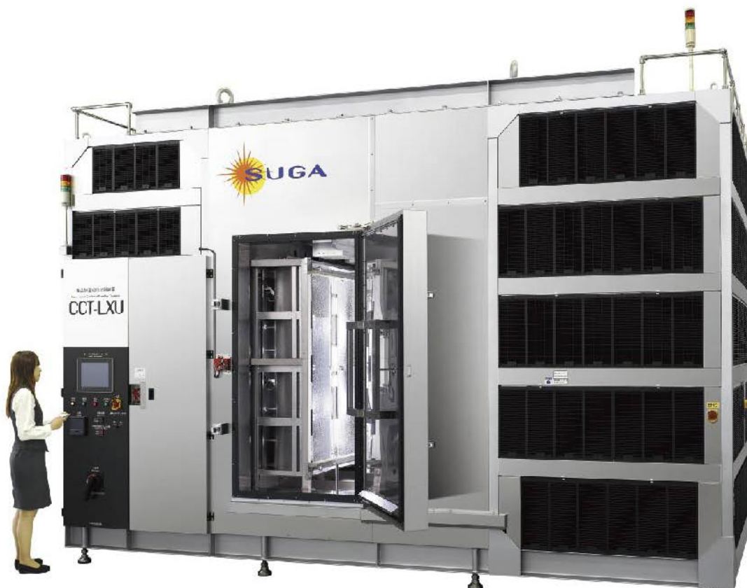
写真2. 複合加速劣化試験装置 (CCT-LXU型) 紫外外部放射照度が太陽光の約3倍 (180W/m 2 ) の高照度促進試験ができ、さらに-30℃～+90℃の広い温度範囲の試験ができます。
