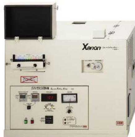
写真3. 分光老化試験機 (SPX型) 劣化波長を解明するために、1枚の試料上に分光照射し試験します。
