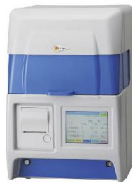
写真6. ヘーズメーター (HZ-V3型) 物質を通過する全光線に対する拡散光の割合をヘーズ値として求めます。本体は試料に合わせて縦置きにも横置きにもできます。
