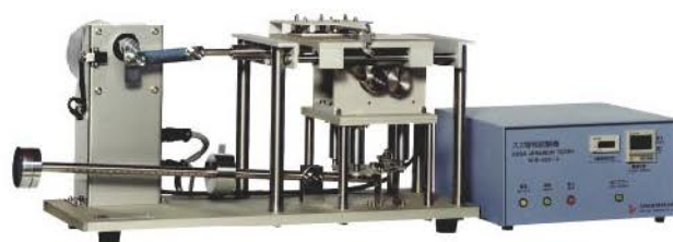
写真13. スガ摩耗試験機 (NUS-ISO3型) 試料が円柱状など成型品の場合、形状に合わせて試料台をカスタマイズすることもできます。
