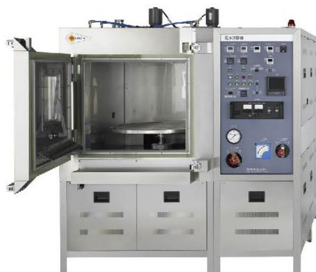
写真12. 泥水試験機 (RA-S型) 車載電子部品用のカスタムモデルです。モバイル製品も試験対象になります。
