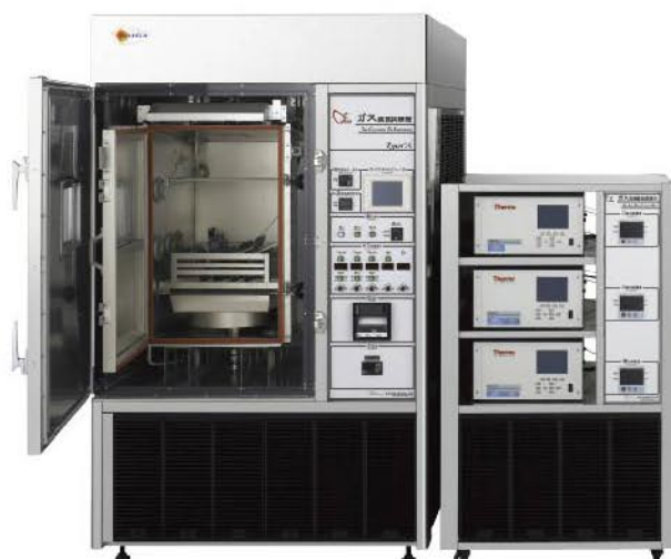
写真5. ガス腐食試験機 (GS-UV型) 腐食性ガスSO 2 、H 2 S、NO 2 、Cl 2 、O 3 等の単独ガス、又は混合ガスに対する耐久性を促進試験します。ガス濃度に影響する試験槽内壁の結露を防止、光学ガス濃度測定法のガス濃度自動制御システムを確立し、再現性の良い試験が可能です。
