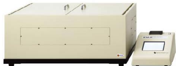
写真9. 写像性測定器 (ICM-1T型) フィルムを透過する像の鮮明度や、反射する像の写り具合を測定します。光沢値やヘーズ値で管理できない差を捉えます。
