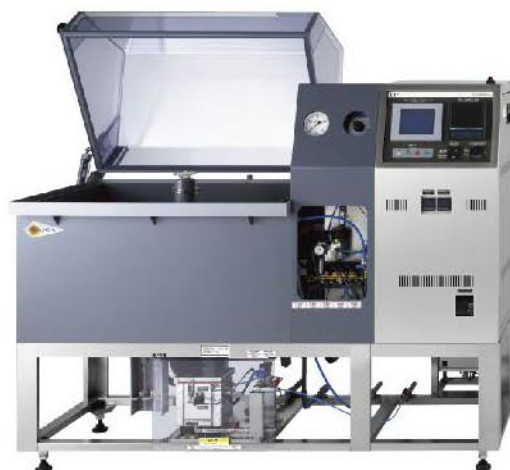
写真4. 塩乾湿 複合サイクル試験機 (CYP-90型) 塩水噴霧・乾燥・湿潤・外気導入の単独試験又はサイクル試験が可能な、コンパクトな複合サイクル試験機です。
