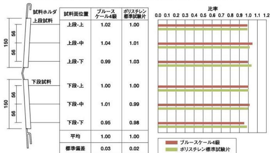
図29 傾斜型試料ホルダのブルースケール・ポリスチレン標準試験片 照射試験結果
