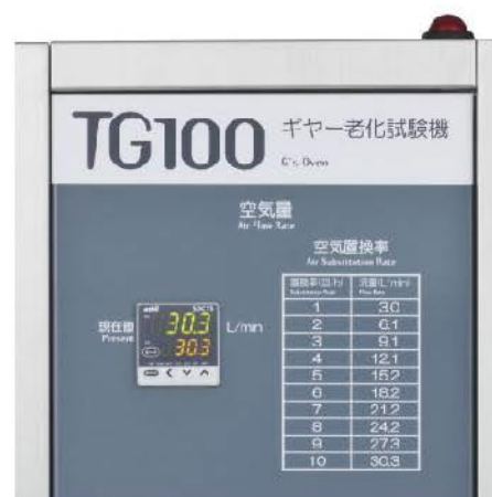
写真1. デジタル流量計表示器と空気置換率対応表
