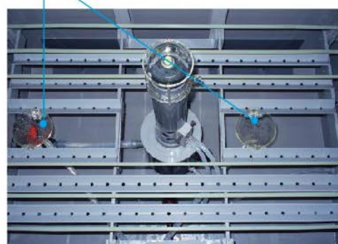
写真2. 標準仕様の試験槽内
