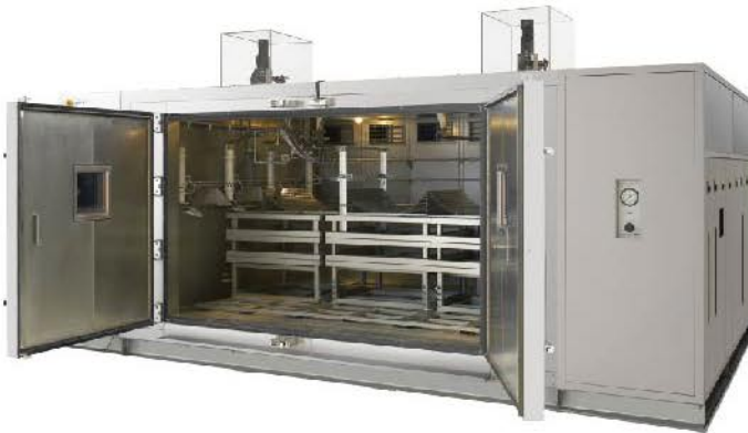
図5 耐候性環境試験室
