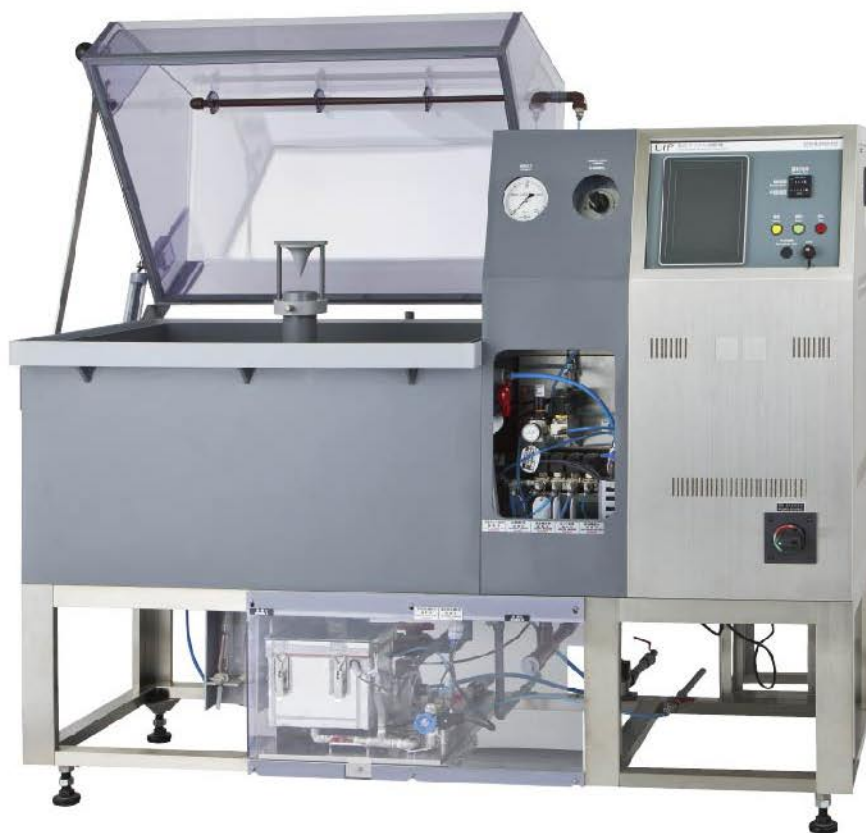
写真1. ルノーECC1サイクルが可能な複合サイクル試験機CYP-90ZNR型
