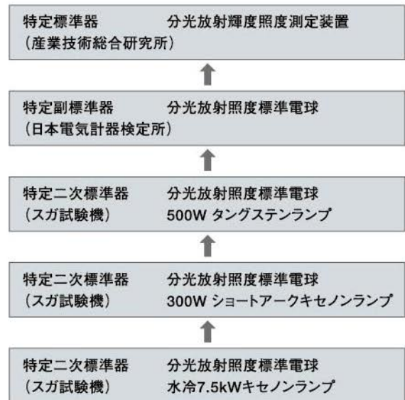
図27 分光放射照度標準電球のトレーサビリティ体系
