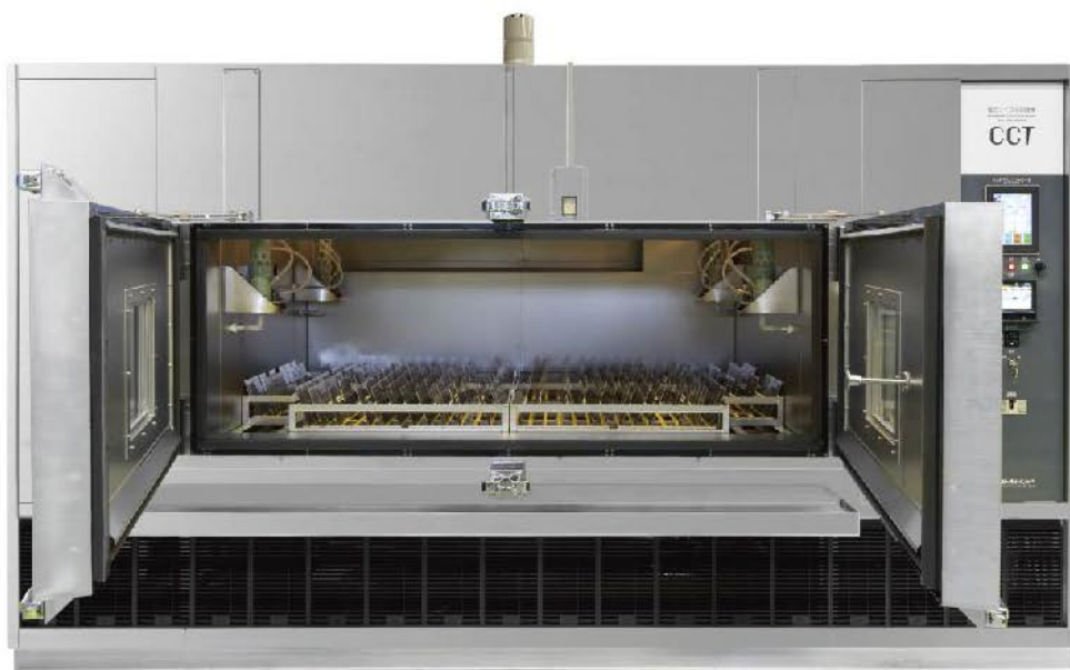
写真2. New-VDA サイクルが可能な複合サイクル試験機 CCT-3LZ 型
