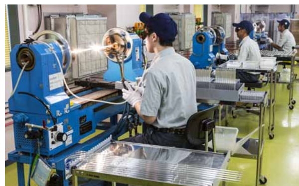
石英ガラス加工 (ガラス加工旋盤でランプ形状に加工します)
