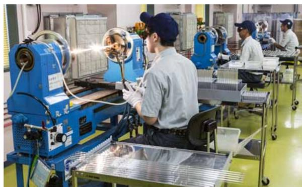
石英ガラス加工 (ガラス加工旋盤でランプ形状に加工します)
