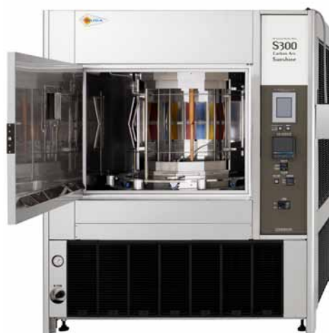
2. カーボン自動交換システムにより300時間連続運転が可能な 300サンシャインウェザーメーター S300型
