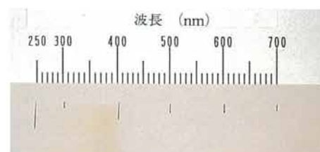
写真11. ポリアセタール板(ベージュ)の100時間照射後
