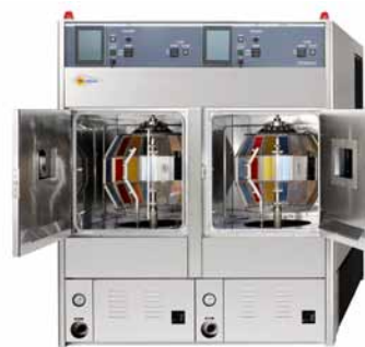
写真13.2槽独立型スーパーキセノンウェザーメーター(SX2D-75型)
