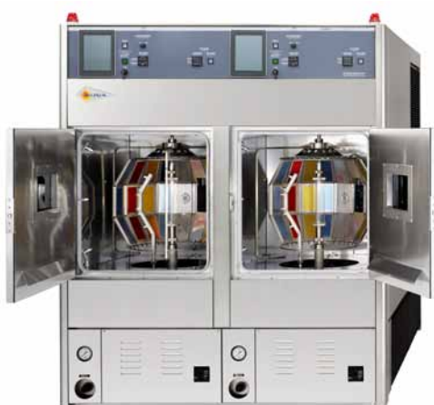
3. 左右槽で異なる試験が可能な 2槽独立型ウェザーメーター SX2D-75型
