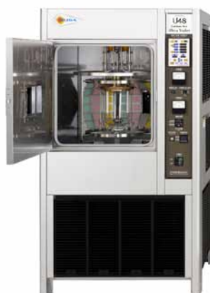
4. 48時間連続運転が可能な 紫外線フェードメーター U48型
