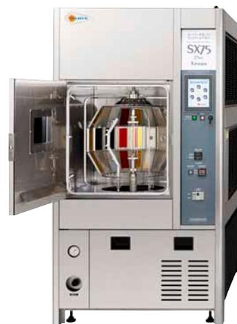
各分野の ISO 規格に規定されている高照度試験 (180W/m<sup>2</sup>) が出来るスーパーキセノンウェザーメーター SX75 型
