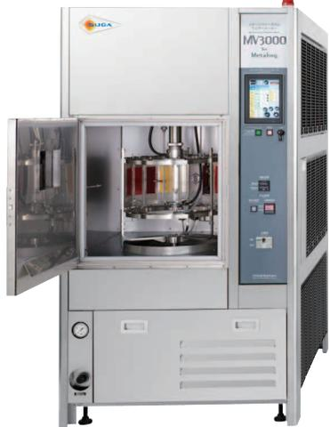
**写真 17.** 垂直点灯方式 3kW メタリング® パーチカルウェザーメーター (MV3000 型)
