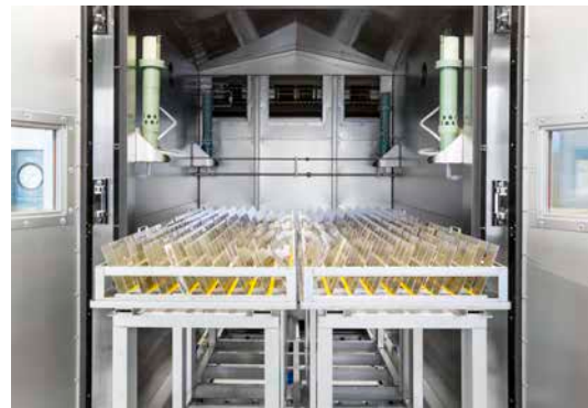
試験片 (150×70mm) が最大432枚試験可能な 試験片保持器 (4分割方式)
