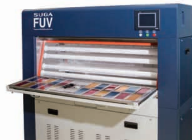
図78 紫外線蛍光灯ウェザーメーターの全体図
