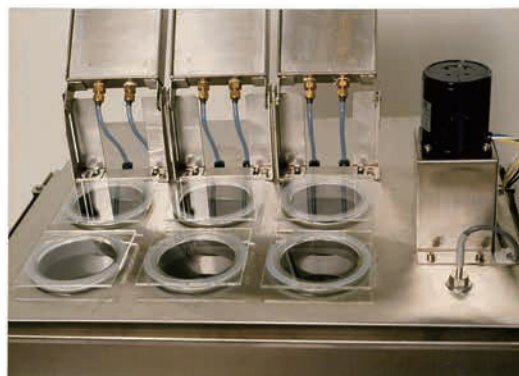
オイル加熱方式 WF-1 型 試験槽上面
