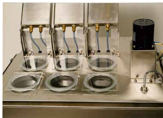
オイル加熱方式 WF-1 型 試験槽上面
