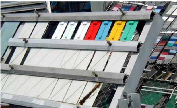
写真18 屋外でのカラーパネル温度計の測定写真
