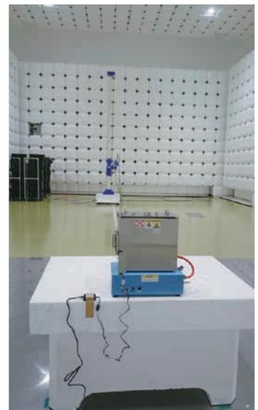
写真左: 複合サイクル試験機 CYP-90CE 型の試験風景 (EMC 試験ラボ 電波暗室にて)
