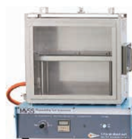
燃焼性試験器 MVSS-3CE 型 (2018.3 宣言)
