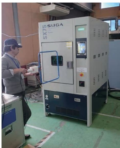
スーパーキセノンウェザーメーター SX75CE 型の試験風景 (日高工場にてオンサイト試験) (規格改正による再試験)
