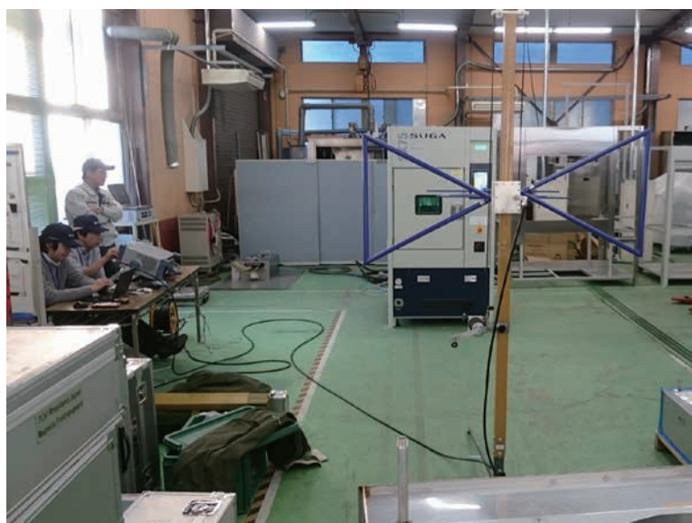
スーパーキセノンウェザーメーター SX75CE 型の試験風景 (日高工場にてオンサイト試験) (規格改正による再試験)
