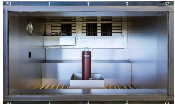
写真1 CCTタイプの複合サイクル試験機試験槽内
