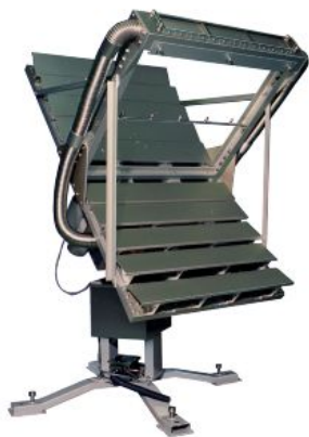
写真5 太陽追跡集光暴露装置
