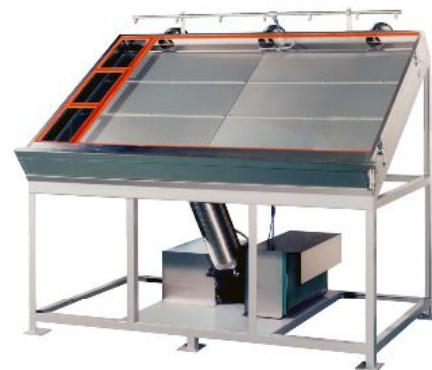
写真3 ガラス越し暴露台(強制通風型)
