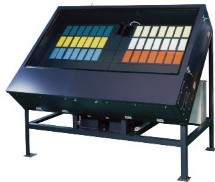
写真4 ブラックボックス暴露台
