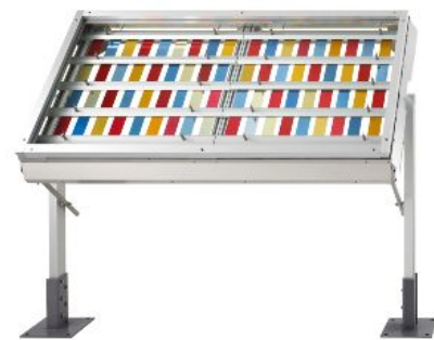
写真2 ガラス越し暴露台(自然通風型)
