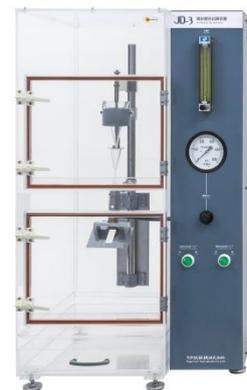
図2. 噴射摩耗試験機 JD-3 型
