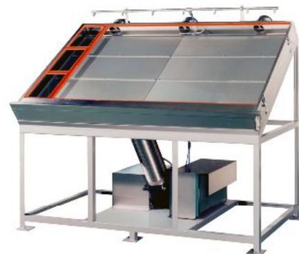
写真3 ガラス越し暴露台(強制通風型)
