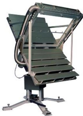
写真5 太陽追跡集光暴露装置
