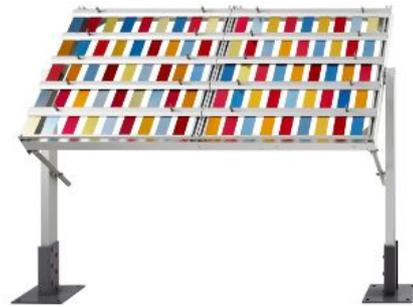
写真1 直接暴露台
