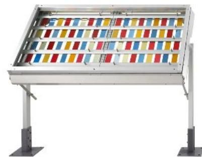
写真2 ガラス越し暴露台(自然通風型)
