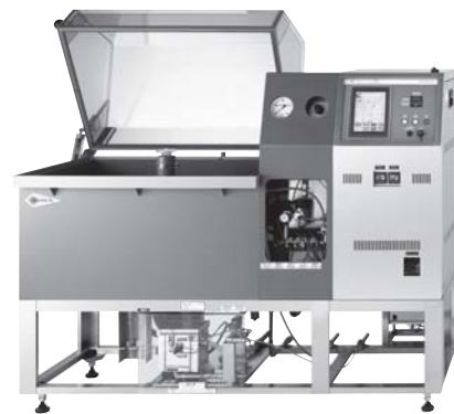
さまざまな腐食試験規格に対応する複合サイクル試験機CYP-90
