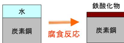
図4 腐食反応のイメージ
