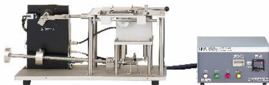
ラウンドロビン試験に使用された スガ摩耗試験機 NUS-ISO3 型
