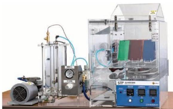
図1 塩水噴霧試験機 STP-30 型
