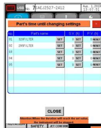
タッチパネルコントローラ設定画面例 (ランプ・フィルタ交換時期を設定)
