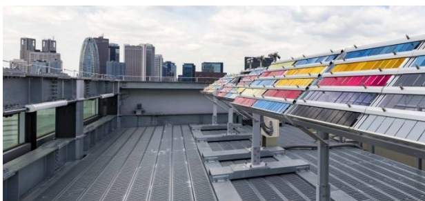
図 17 スガ試験機本社ビル屋上暴露試験場での大気暴露試験の状況
