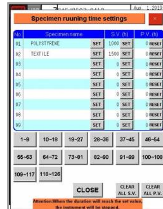
タッチパネルコントローラ設定画面例 (試験片ごとの試験時間を設定)
