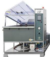
試料回転機構付きの腐食促進試験機
