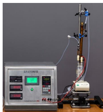
図2 塩素ガス濃度測定装置外観
