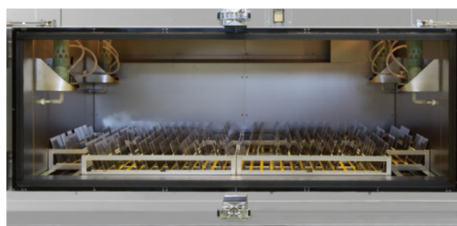
試験槽内部 (写真は槽内寸法が幅 200 × 奥行 100 × 高さ 120cm の CCT-3LZ 型)
