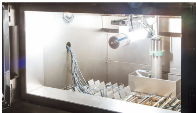
試験槽内部 (光源：7.5kW 水冷のキセノンランプ)※2
