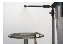
■ 散水試験 JIS D 0203 R1・R2
