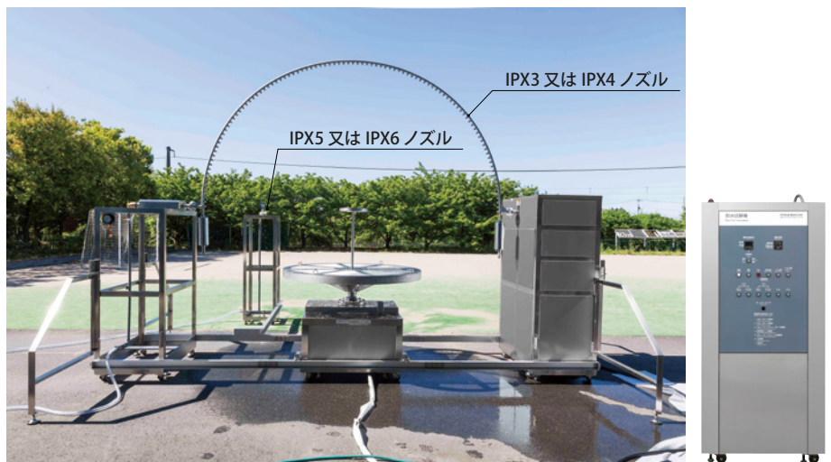
写真はオシレーティングチューブ半径 1,600mm による IPX4 試験時 (本装置は屋内仕様ですが、屋外で試運転時に撮影。屋内で試験する際は試験室の防水処置が必要です。)
