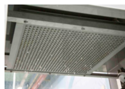
■ 滴水試験 IP コード IPX1・IPX2
