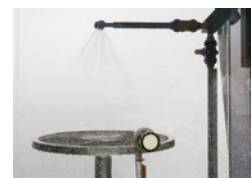
■散水試験 JIS D 0203 R1・R2
