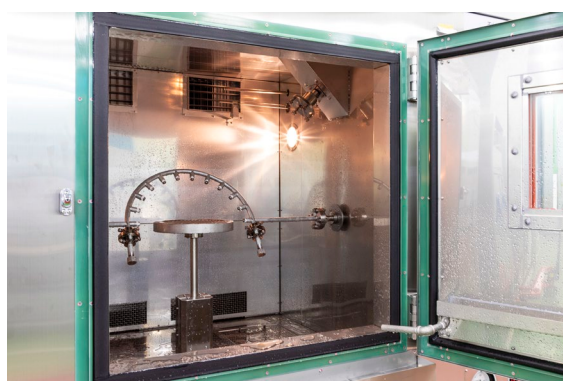
写真1 オシレーティングチューブを用いた耐水試験
