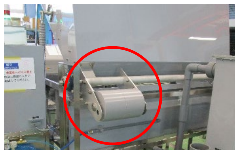
図3 試験機の背面(赤丸部分が重り)
